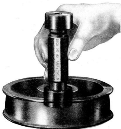
Fig. 5. Verificarea alezajelor cu calibrul tampon cilindric
