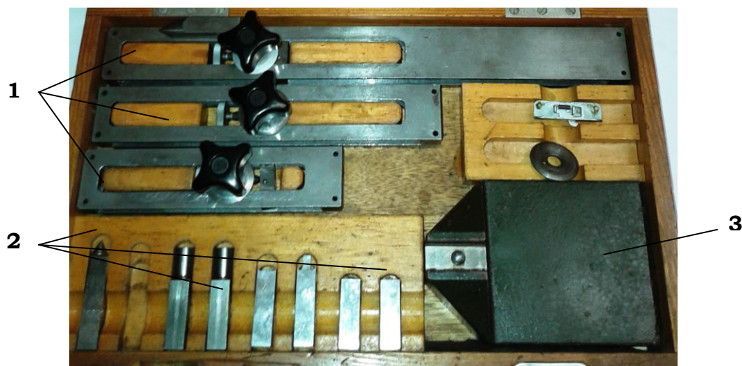
Fig. 3. Trusa de accesorii 1-cadre pentru cale plan- paralele; 2- cale marginale, 3- talpă
